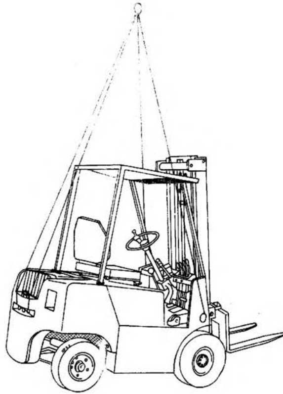
Рис. 30 Схема мест присоединения тросов при транспортировке погрузчика
